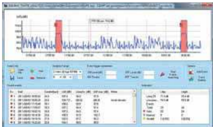
Noise Studio: Modulo NS2A "Inquinamento acustico": rumore da traffico ferroviario, analisi sulle 24 ore con ricerca automatica dei transiti.
